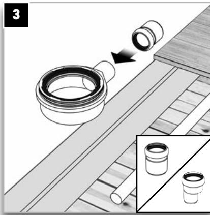
**( DE ) Schritt 3** – Dieser Schritt wird nur benötigt, wenn der DN 50-Anschluss des waagerechten Ablauftopfs reduziert werden muss!
